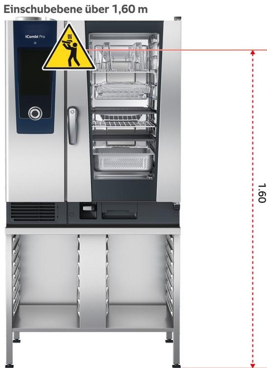
Wenn Ihr Gerät so installiert wurde, dass die oberste Einschubebene 1,60 m über dem Boden liegt, müssen Sie das mitgelieferte Warnzeichen an dieser Stelle anbringen.
