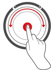
Anstelle der Gesten [► 18] können Sie Einstellungen durch Drehen des zentralen Einstellrads ändern. Aktionen bestätigen Sie durch Drücken des zentralen Einstellrads.
